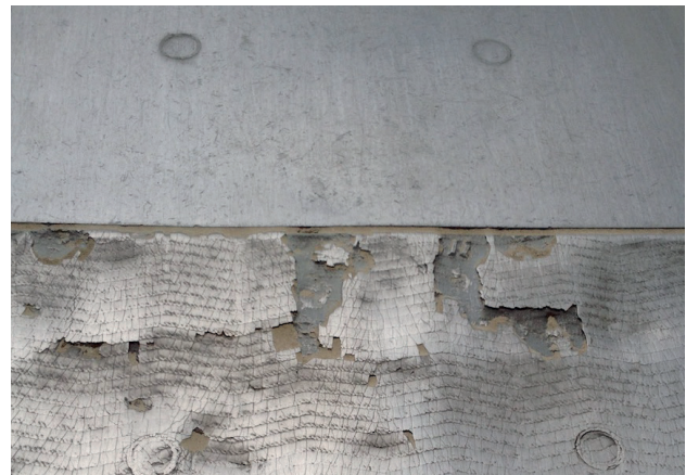
Almindelig hardface plade sammenlignet med ABRATEK CFP slidplade med glat overflade, efter 8 måneders brug.
